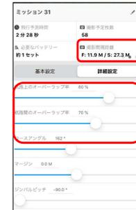
例えば、高度100mで飛行させる場合、撮影間隔距離はF:17.1m/S:38.9mとなるが、航路上を86%、航路間を79%とすることで70m時と同程度の撮影間隔となる。
