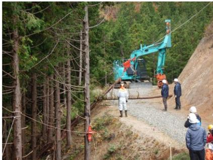
写真① 先柱を用いて材が搬出される様子
